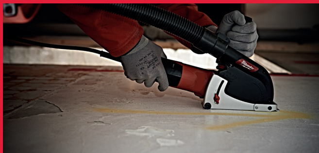
АРТ.# 4932430467 DEC125 Пылезащита для резки - DEC 125. 100% бесключевая установка на УШМ Ø 115 - 125 мм AG(V) 12, AGV 15 серий и FUEL™ углошлифмашины
