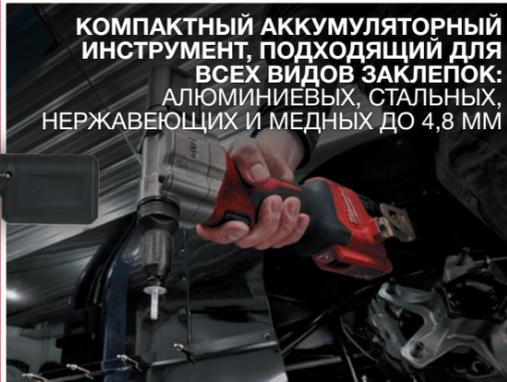
**КОМПАКТНЫЙ АККУМУЛЯТОРНЫЙ ИНСТРУМЕНТ, ПОДХОДЯЩИЙ ДЛЯ ВСЕХ ВИДОВ ЗАКЛЕПОК: АЛЮМИНИЕВЫХ, СТАЛЬНЫХ, НЕРЖАВЕЮЩИХ И МЕДНЫХ ДО 4,8 ММ**
