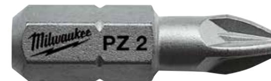
Ребра насадки производятся с помощью холодной штамповки в соответствии с точной спецификацией. Кончик насадки проходит специальный процесс закалки при температурах до 870°C
